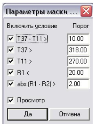
Рисунок 98. Диалог настройки параметров маски пожаров по данным NOAA HRPT
